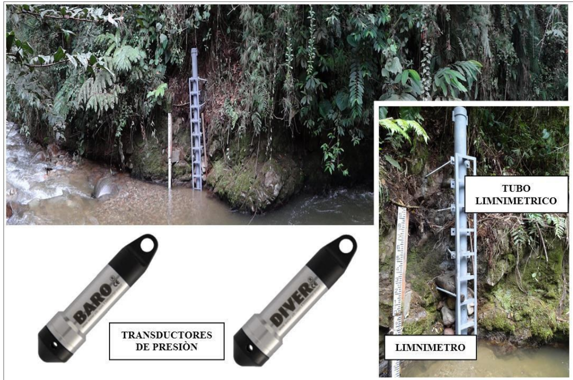
Figura 4. Estación automática de niveles El Rasgón
